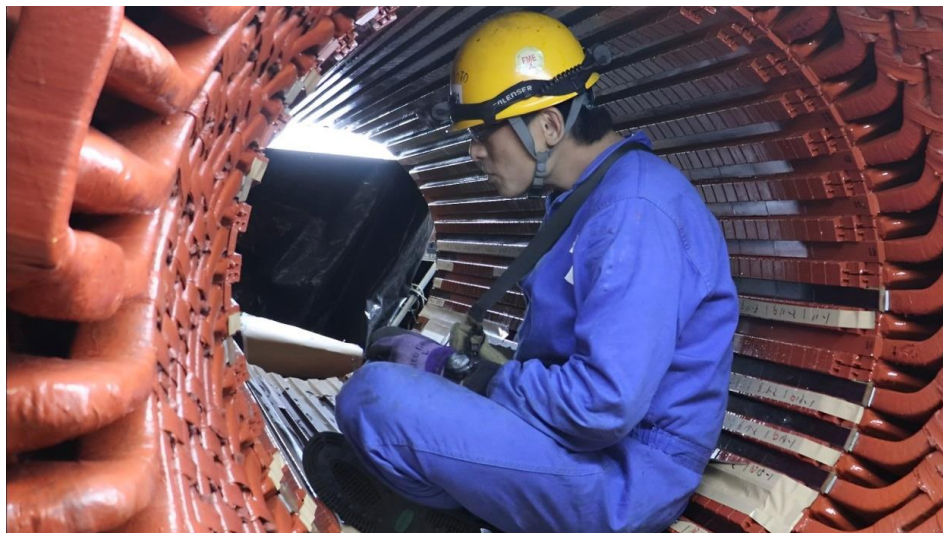
TFA (Asesor Técnico de Campo) Mitsubishi Japón - Reacuíado estator.
